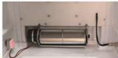
Note : chaque cabine a un ventilateur séparé. Le ventilateur de la machine doit fonctionner en permanence. Vérifiez le ventilateur quotidiennement et assurez-vous qu'il fonctionne correctement.
