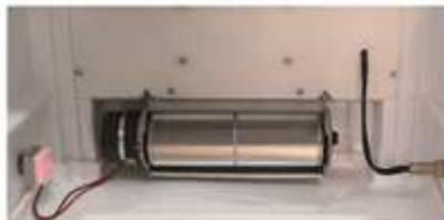
ote : Le ventilateur de la machine doit fonctionner en permanence. Vérifiez le ventilateur quotidiennement et assurez-vous qu'il fonctionne correctement.
