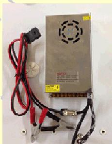
هر کابین دارای یک پاور ۳۰ آمپر است که طریقه نصب آن به شکل بالا می باشد. هنگام قطع برق همانند شکل فوق انبر های اتصال به باطری را به پاور نصب کنید. هنگام اتصال به باطری دقت کنید که انبر قرمز به مثبت و انبر مشکی به منفی باطری وصل شود. در زمان وصل بودن برق ، پاور باطری را شارژ می کند.
