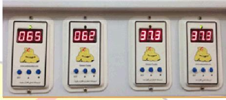
در حالت عادی کنترلر های اصلی دما و رطوبت داخل مدار قرار دارند . در شرایط نرمال عددی که دو کنترلر دما نشان می دهند با چند دهم اختلاف باید نزدیک بهم باشد. همچنین عددی که کنترلر های رطوبت نشان می دهند با یک تا ۵ درصد اختلاف باید نزدیک بهم باشد.
