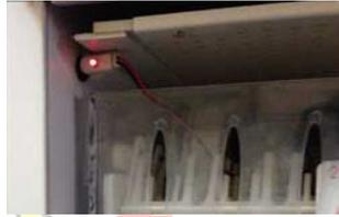
فیش موتور ها را به محل مشخص شده نصب کنید. دقت کنید که سیم موتور کاملا داخل سیگنال محکم شده باشد.
