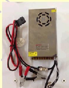
دستگاه دارای یک پاور  $30\text{ آمپر}$  است که طریقه نصب آن به شکل بالا می باشد. هنگام قطع برق همانند شکل فوق انبر های اتصال به باتری را به پاور نصب کنید. هنگام اتصال به باتری دقت کنید که انبر قرمز به مثبت و انبر مشکی به منفی باتری وصل شود. در زمان وصل بودن برق ، پاور باتری را شارژ می کند.
