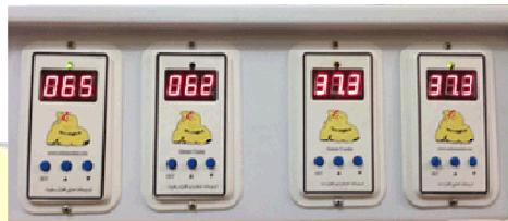
در حالت عادی کنترلر های اصلی دما و رطوبت داخل مدار قرار دارند . در شرایط نرمال عددی که دو کنترلر دما نشان می دهند با چند دهم اختلاف باید نزدیک بهم باشد. همچنین عادی که کنترلر های رطوبت نشان می دهند با یک تا ۵ درصد اختلاف باید نزدیک بهم باشد.
